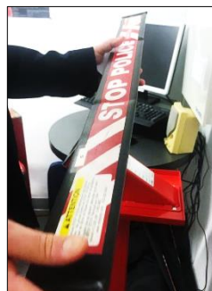
Barre légère faisant l'effet d'une herse pour stopper un véhicule en lui crevant les pneus : 300 € pièce environ
